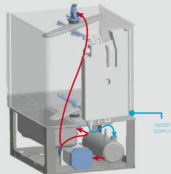
независимой от давления в сети, благодаря наличию Break Tank. Таким образом, ополаскивание обеспечивается также при очень низком давлении. Температура воды остается постоянной на протяжении всего ополаскивания, так как восстановление воды в бойлере осуществляется по окончании ополаскивания, избегая смешивания.
